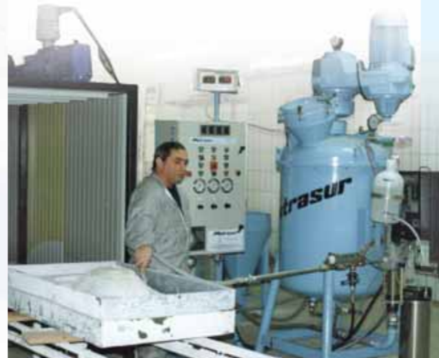
Injection unit for degassed filled resin Injection de béton polymère dégazé
