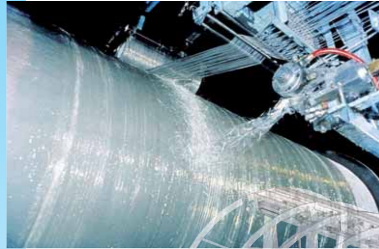
Chop-hoop winding Projection simultanée et enroulement fils roving
