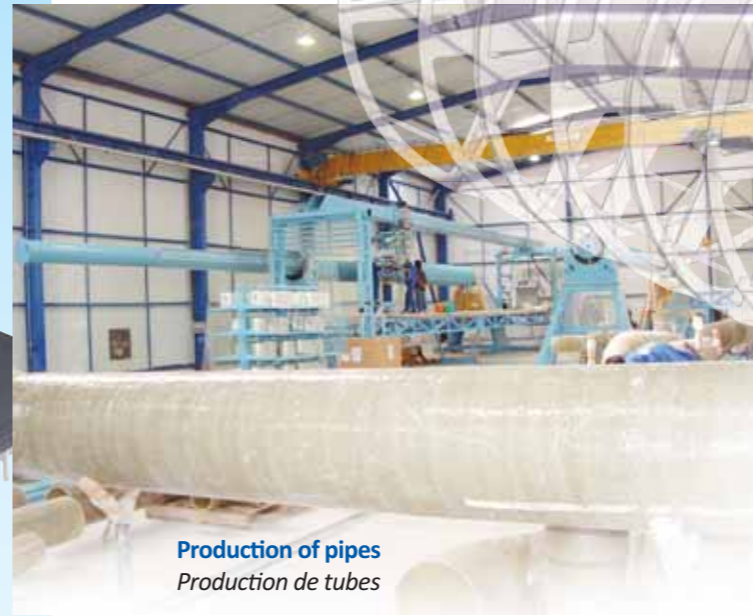
Chop-hoop winding Projection simultanée et enroulement fils roving
