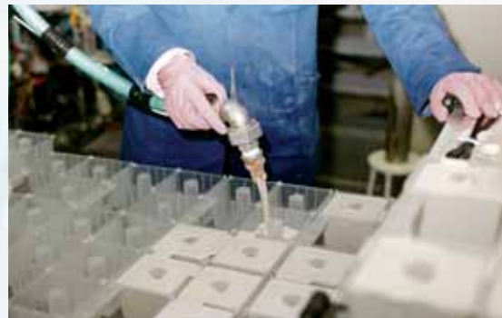
Casting unit for degassed filled resin Coulée de béton polymère dégazé
